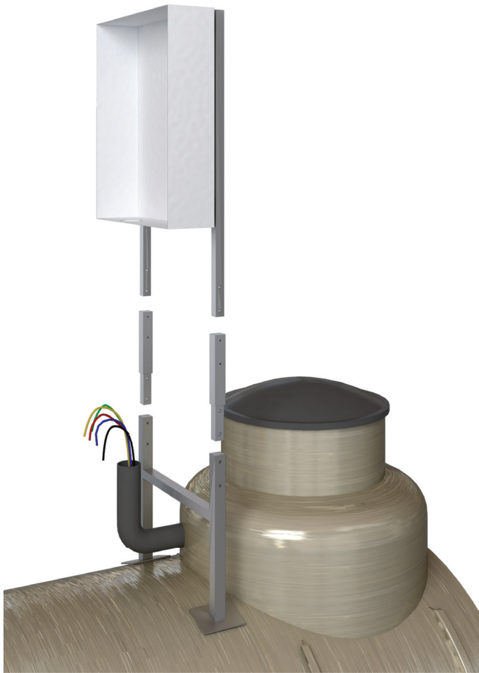
Figur 10: Påse at skapet blir stående loddrett på stativet med baksiden av skapet vendt mot lokket på tanken..
