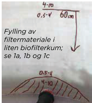
Fyllingsmerker for filtermateriale i liten kum se 1a, 1b og 1c
